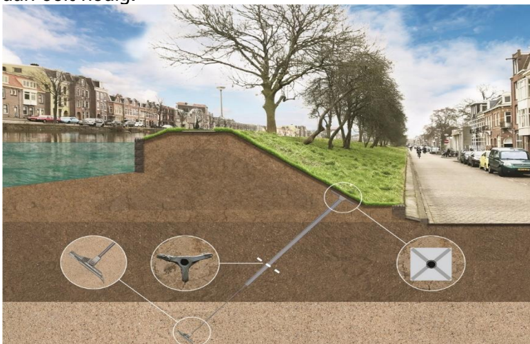
Versterking van de Ringdijk Watergraafsmeer in Amsterdam.
